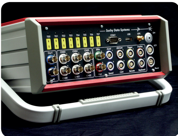
Bild 4: Bis zu 600 dezidierte Messkanäle kann das Suchy-Testsystem bearbeiten, 8 bis 88 Thermoelement-Eingänge (gelb) sind bereits in der Standardkonfektionierung vorgesehen.
